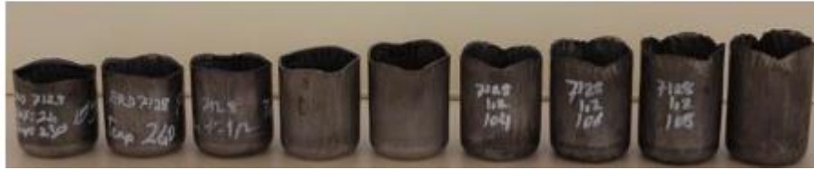
Şekil 6. HC300LA sacına ait, t=1,2 mm sac malzemesine ait, WDD prosesiyle şekillendirilmiş kaplar.
