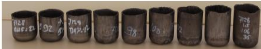
Şekil 7. HC300LA sacına ait, t=1,2 mm sac malzemesine ait, WDD prosesiyle şekillendirilmiş kaplar.
