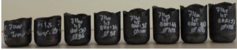
Şekil 11. HC420LA sacına ait, t=1,5 mm sac malzemesine ait, WDD prosesiyle şekillendirilmiş kaplar.
