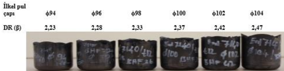
Şekil 10. HC420LA sacına ait, t=1,2 mm sac malzemesine ait, WDD prosesiyle şekillendirilmiş kaplar.
